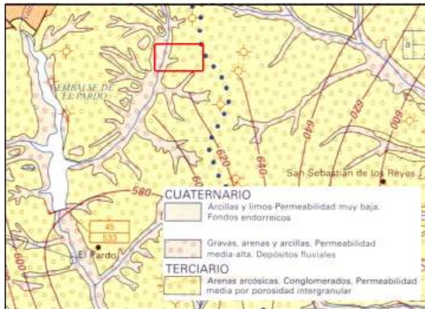
**Figura 9.** Esquema hidrogeológico 1:200.000 (reducido).
